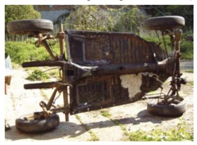
ON A SUNNY DAYTAKE THE FLOORPAN OUTSIDE AS THIS IS THE BEST PLACE TO WIRE BRUSH OFF THE SURFACE RUST.
