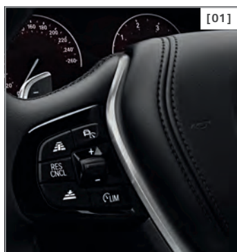
[01] Aktive Geschwindigkeitsregelung mit Stop&Go-Funktion
